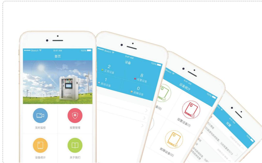
电气火灾监测系统APP作为一种全新的管理模式，为日常智能化管理、电气火灾隐患排查治理及安全生产工作提供了新思路、新方法。管理人员通过手机即可查看前端用电检测预警设备电气线路实时运行数据，并可通过手机远程一键操作。发现电气火灾隐患，将报警提示信息推送给用户，形成电气火灾隐患从发现、监管到治理的有效闭环。
